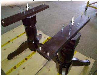
14. Перевернуть опорный каркас с поперечными планками на крышку стола. При помощи шестигранного ключа закрутить винты (4 шт)
