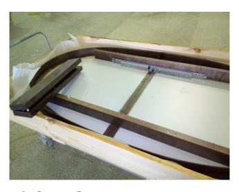
6. Снять блокировку с шариковых направляющих при помощи стопора
