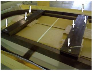
4. Снять поперечные планки каркаса
