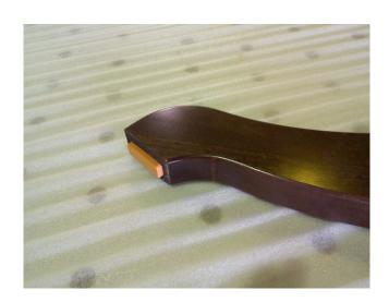
10. В среднюю царгу закрутить винты (2 шт) при помощи гайки глухаря и ключа. Забить шкант 8х35 (1 шт)
