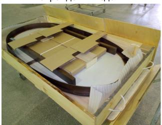
3. Выкрутить 4 транспортных самореза и 4 винта (шестигранным ключом)
