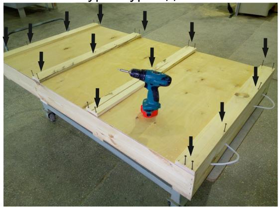
Упаковку №1 поставить на пол и при помощи шуруповерта или отвертки выкрутить саморезы. Фурнитура здесь!
