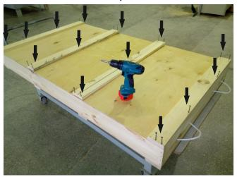
2. При помощи отвертки отрыть фанеру, которая закреплена на скобы, и убрать в сторону во избежании травмирования и повреждения изделия
