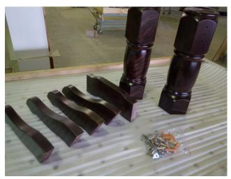
8. В опорные ноги (4 шт) закрутить винты (2 шт) при помощи гайки глухаря и ключа. Забить шкант 8х35 (1шт)
