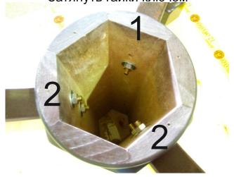
13. Перевернуть опорный каркас и установить поперечные планки шкантами вверх. При помощи шестигранного ключа закрутить евровинты (8 шт)
